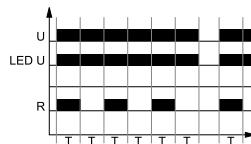
Включение напряжения питания U, начинает отсчёт установленного времени T, с одновременным включением исполнительного реле R. После отсчёта времени T, исполнительное реле R возвращается в начальное состояние и начинается повторный отсчёт времени T. Циклическая работа реле длится до момента выключения напряжения питания U.
