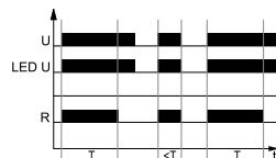
Включение напряжения питания U, сразу срабатывает исполнительное реле R и начинает отсчёт установленного времени T. После отсчёта времени T, исполнительное реле R возвращается в исходное состояние.
