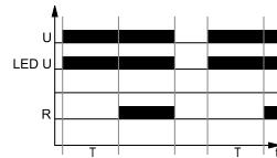
Включение напряжения питания U, начинает отсчёт установленного времени T - задержки включения исполнительного реле R. После отсчёта времени T, исполнительное реле R срабатывает и находится в позиции работы до момента отключения напряжения питания U.
