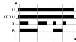
Напряжение питания U должно подаваться на реле времени непрерывно. При включении контакта управления S, сразу срабатывает исполнительное реле R. Каждое последующее включение контакта управления S, приводит к изменению состояния исполнительного реле на противоположное (свойство бистабильного реле).
